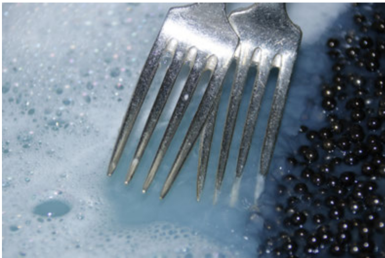
Tafelgeräte in Silber benötigen einen stetigen Unterhalt. Das Silber im Hotel Arvenbüel wird zweimal jährlich mit der Kugelpoliermaschine gehärtet. So sehen die teilweise 60-jährigen Silberteile noch heute aus wie neu und machen jeden Tag ein bisschen wertvoller.
